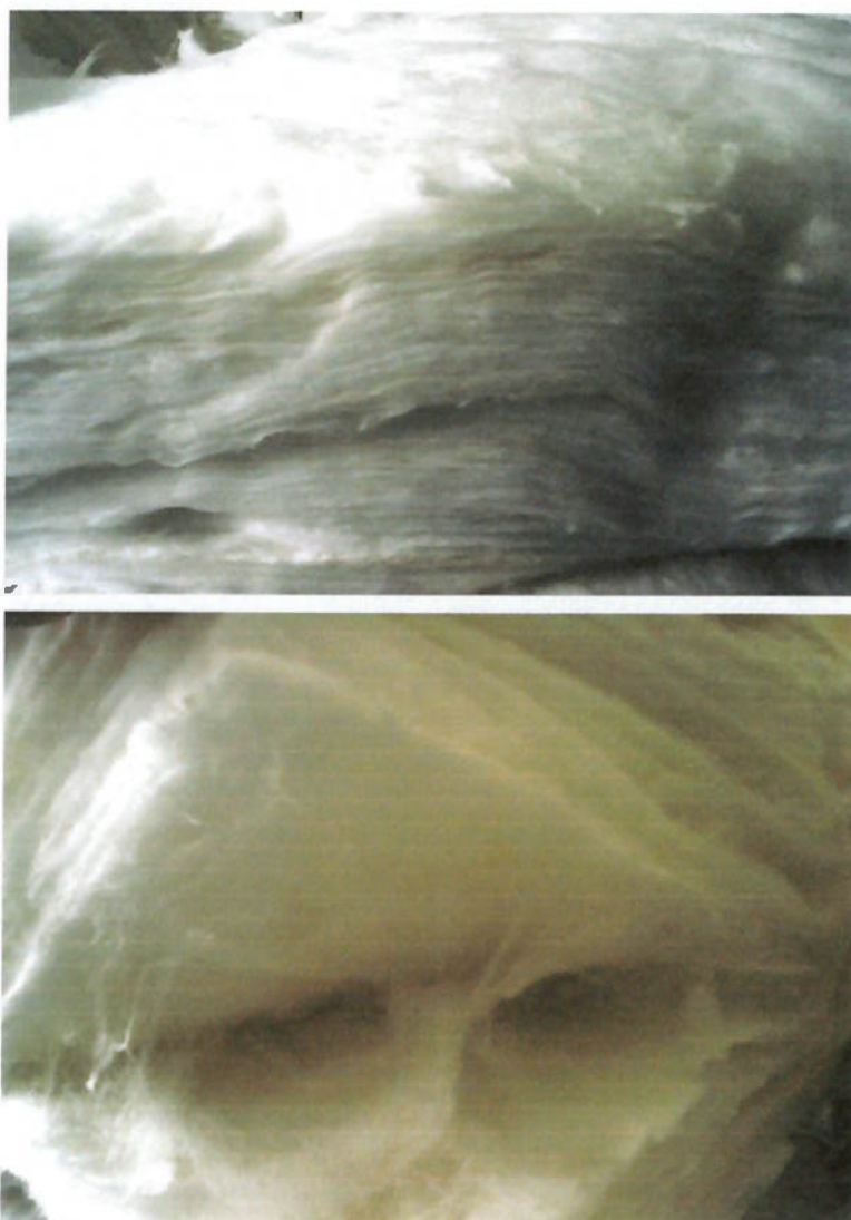
Figuras 8 e 9 - PLR com problemas de qualidade (em estado de delaminação). Note que as fibras do produto entrelaçam-se umas às outras.
