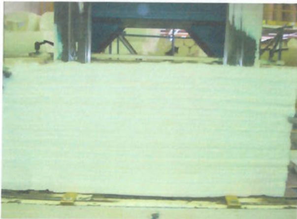
Figura 14 - PLR sem delaminação.
